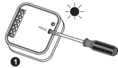
1 Нажать кнопку PROG устройства SRP-02 и придержать ее до загорания (постоянный сигнал) красного диода LED. Отпустить кнопку PROG.
