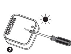
2 Нажать кнопку PROG устройства SRP-02 и придержать ее до загорания (постоянный сигнал) красного диода LED. Отпустить кнопку PROG. Подождать (около 5 с) пока диод LED загорится (мигающий сигнал, а потом постоянный).
