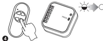
4 Нажать и потом отпустить вторую кнопку передатчика (движение ▼). Диод LED загорится (мигающий сигнал), а потом потухнет – ПЕРЕДАТЧИК ЗАПИСАН.
