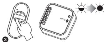
3 Нажать и потом отпустить первую кнопку передатчика (движение ▲). Загорится (мигающий сигнал, после постоянный) красный диод LED.
