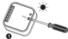
1 Нажать кнопку PROG устройства SRP-02 и придержать ее до загорания (постоянный сигнал) красного диода LED. Отпустить кнопку PROG. Подождать (около 5 с) пока диод LED загорится (мигающий сигнал, а потом постоянный).
